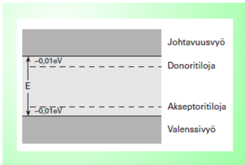
Kuva 3.5: Termolisteilmaisimen toimintaperiaate (Ikäheimo 2002, 132)
