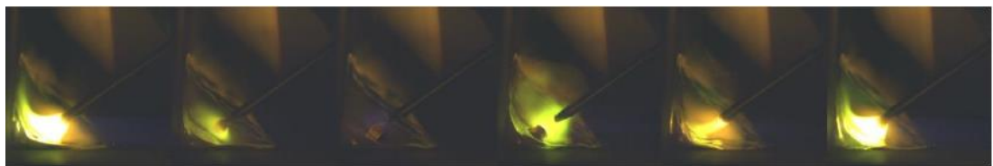
Kuva 5. Kuvasarja MAG-pulssihitsauksesta käyttäen WiseFusion™-toimintoa (Kumpulainen, 2009, s. 2).
