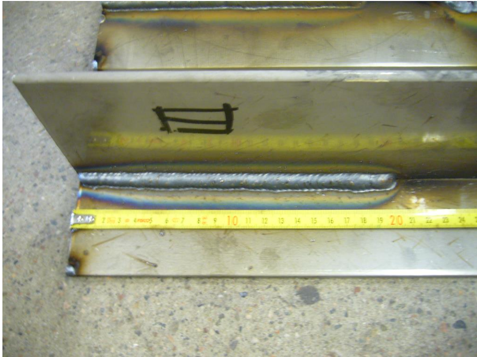
Kuva 16. MAG-lyhytkaarihitsauksella hitsattu 4 mm a-mitta (Aki Riikonen).
