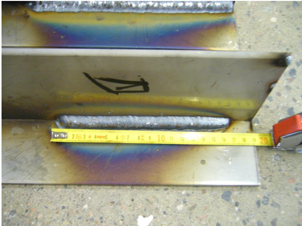
Kuva 17. MAG-lyhytkaarihitsauksella hitsattu 6 mm a-mitta (Aki Riikonen).
