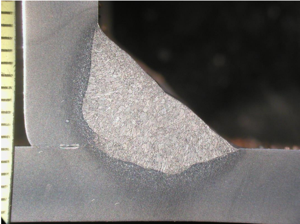
Kuva 22. WiseFusion™-toiminolla varustetulla Pulssi-MAG-hitsauksella hitsattu 6 mm a-mitta (Aki Riikonen),
