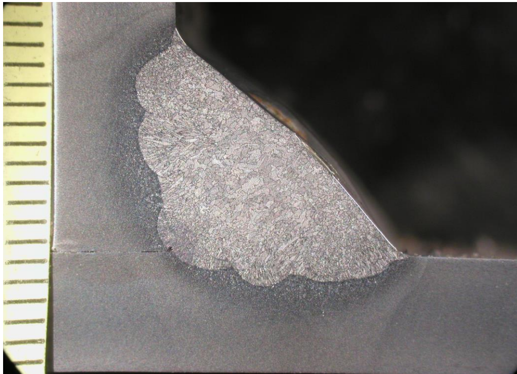
Kuva 23. MAG-lyhytkaarella hitsattu 6 mm a-mitta (Aki Riikonen),
