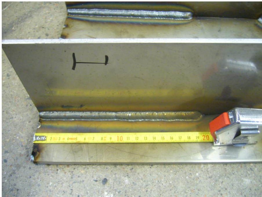
Kuva 14. WiseFusion™-MAG-pulssihitsauksella hitsattu 4 mm a-mitta (Aki Riikonen).
