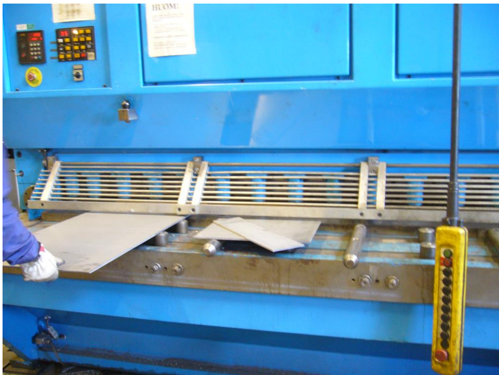
Kuva 12. Finn-Power-levyleikkuri (Aki Riikonen).
