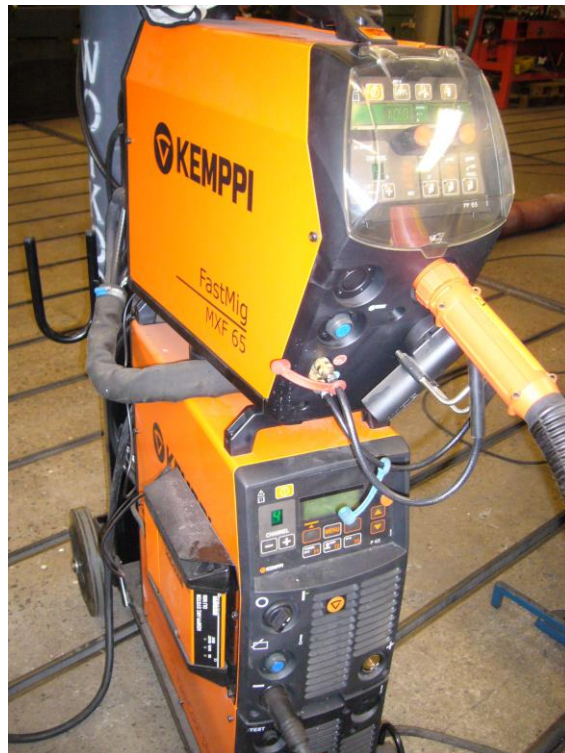
Kuva 11. Kemppi Oy:n FastMig Pulse 450 -hitsauslaitteisto (Aki Riikonen).
