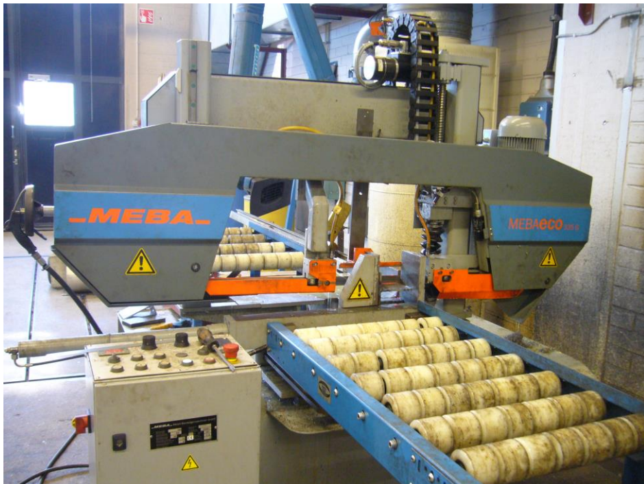
Kuva 18. Meba 355 G -puoliautomaattinen vannesaha. (Aki Riikonen).
