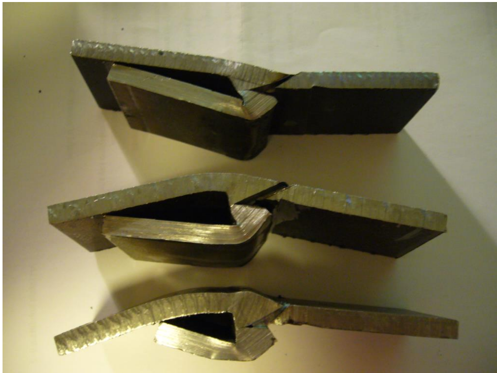
Kuva 27. Epäonnistuneita murtokokekappaleita (Aki Riikonen).
