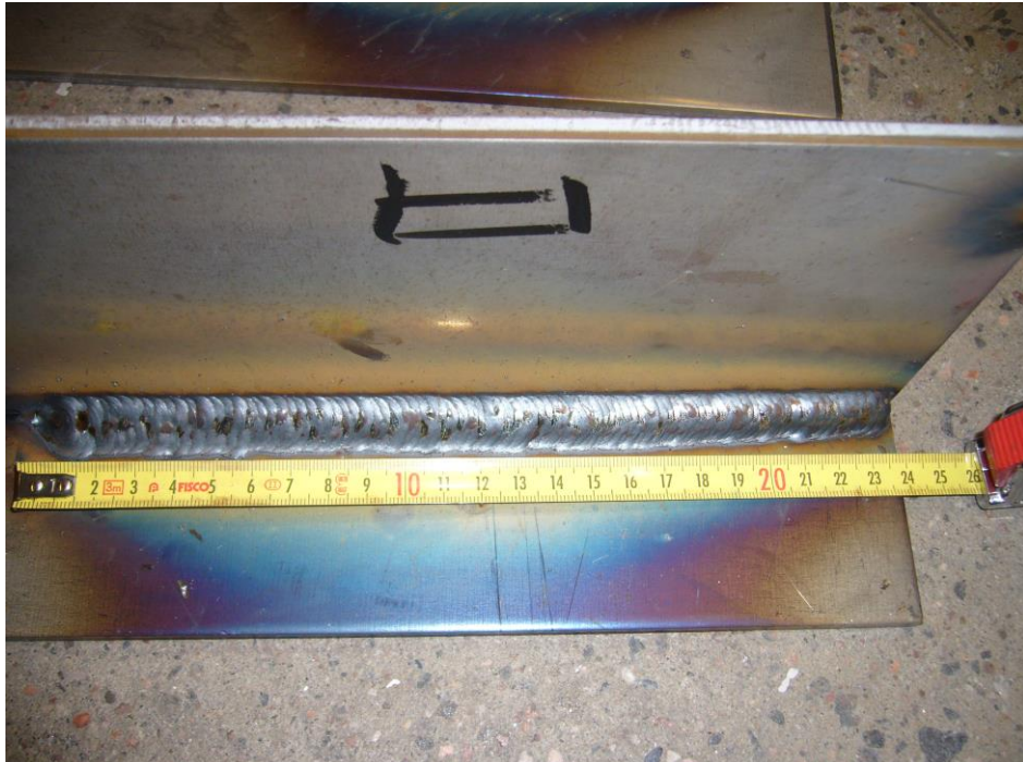
Kuva 15. WiseFusion™-MAG-pulssihitsauksella hitsattu 6 mm a-mitta (Aki Riikonen).
