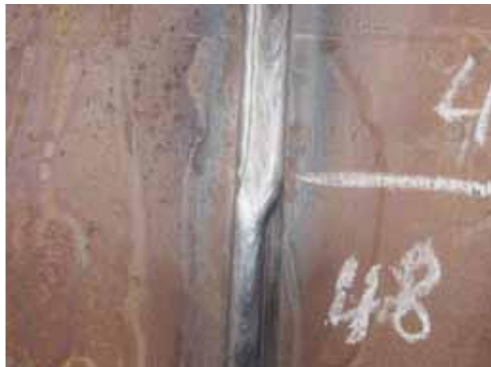
Kuva 18. Hitsauslaitteisto siirtyy automaattisesti toiselle reunalle railoa joka kierroksen jälkeen (Stano & Matejec, 2010.)
