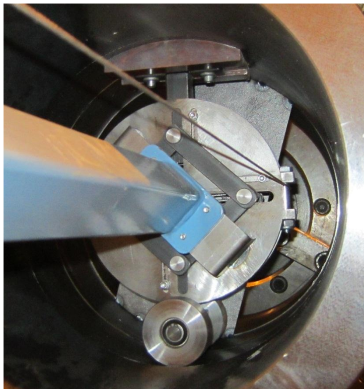
Kuva 49. Juuritukilaite koekappaleen sisällä.
