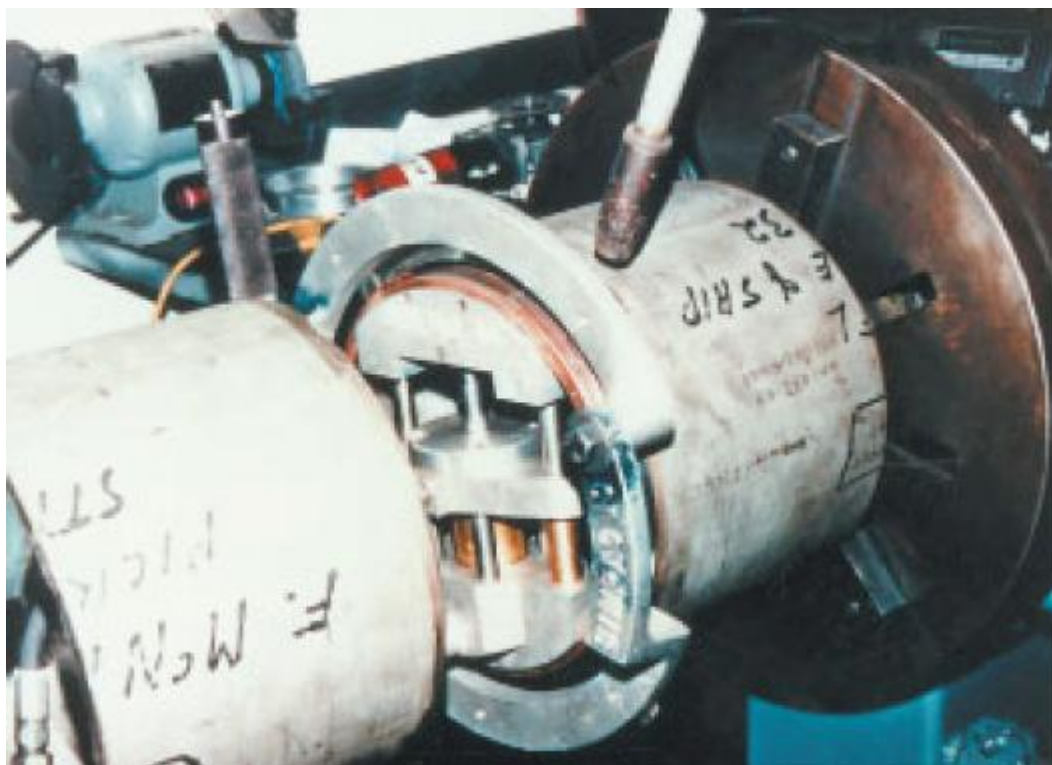
Kuva 25. Hydraulisesti toimiva putkien päittäisliitoksen hitsauksen juuritukilaite (Hahn, 2004.)
