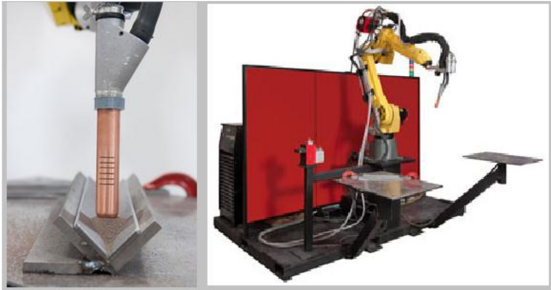
Kuva 12. Robotisoitu jauhekaarihitsaus (Nadzam, 2013.)
