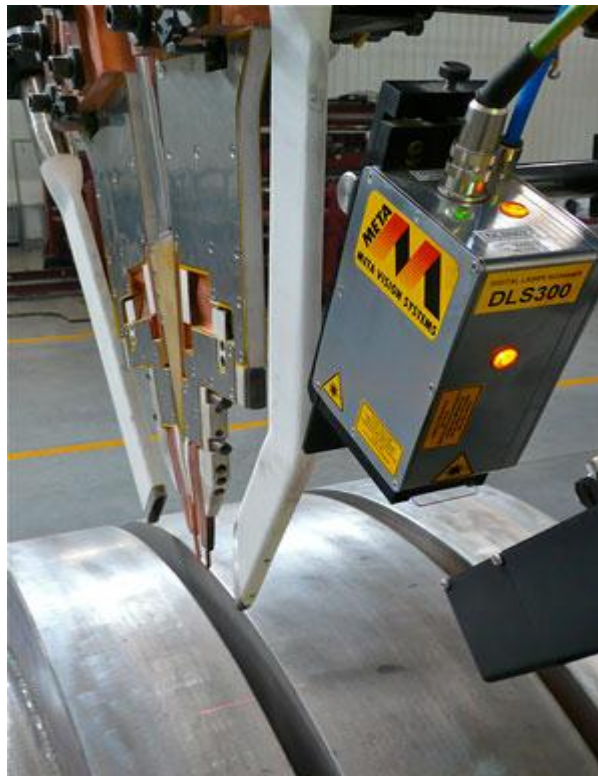
Kuva 14. Tandem-kapearailohitsauspäätä varustettuna optisella railonseurannalla (Heston, 2010.)
