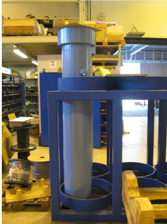
Kuva 2. Valmis puristussylinterin sylinteri-osa. Kuvassa sylinterin kaulus on ylhäällä ja sylinterin pohja alhaalla.
