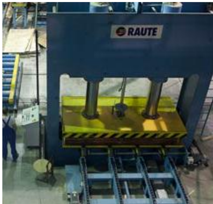
Kuva 1. Vanerin esipuristin, jossa on kaksi puristussylinteriä (Määttänen, 2013.)
