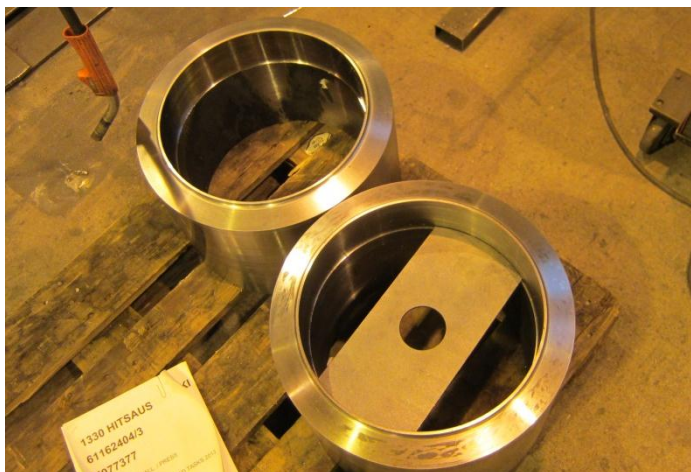
Kuva 41. Menetelmäkoekappaleet jauhekaarhitsaukseen koneistettuna. Kuvassa oikeanpuoleinen putki vastaa sylinterin pohjakappaletta ja vasemmanpuoleinen sylinteriputkea.
