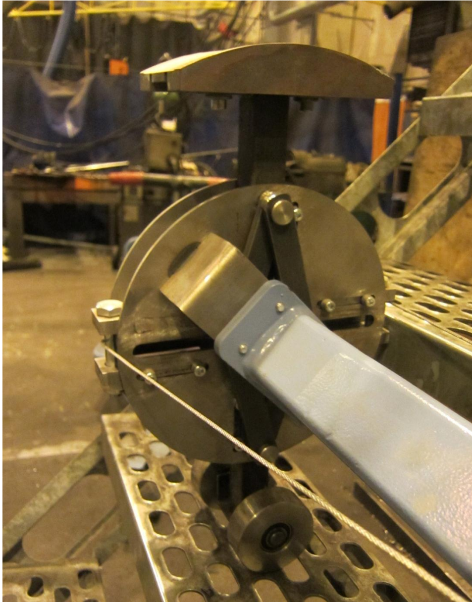
Kuva 40. Valmis juuritukilaite. Kuvassa ylhäällä on kuparinen juurituki, joka painetaan juuripintaa vasten.
