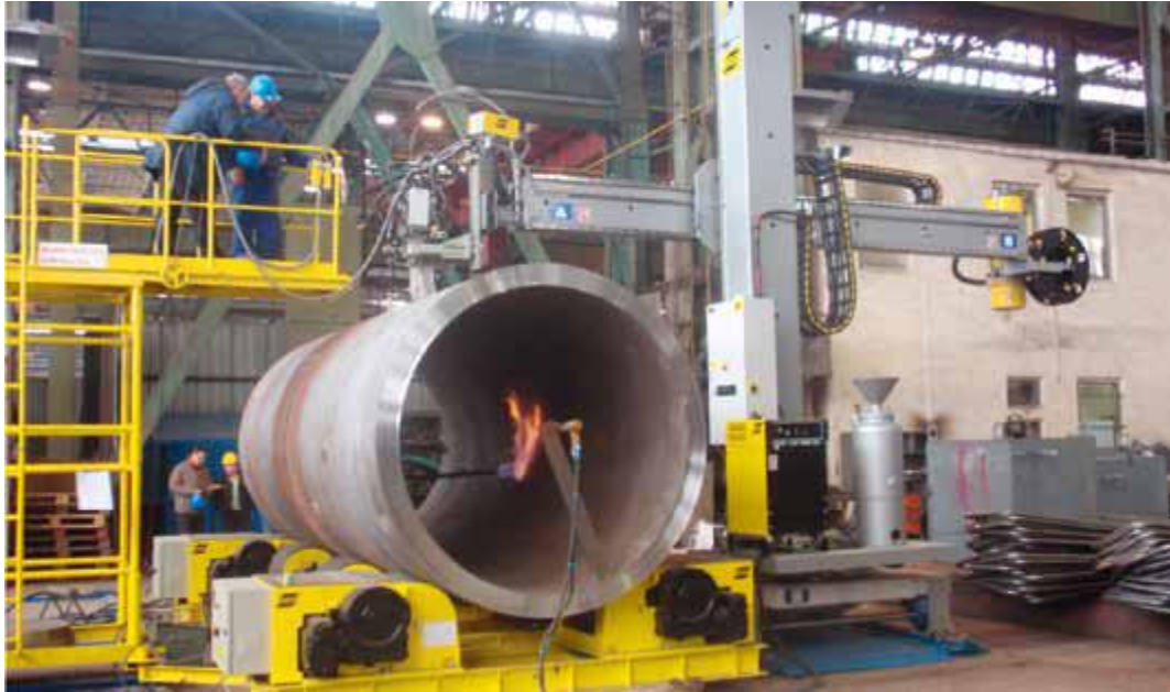
Kuva 17. Automatisoitu jauhekaarihitsauslaitteisto järeiden paineastioiden hitsauksessa (Stano & Matejec, 2010.)
