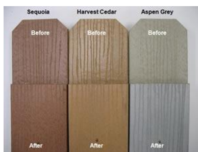
Kuva 2. Tuotteen C värinmuutos 2500 tunnin säänkestävyyskokeen jälkeen.
