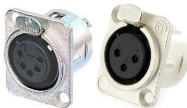
Kuva 4.3 Vasemmalla XLR-5- ja oikealla XLR-3-naarasportti. XLR-5:ssä on 5 pinniä ja XLR-3:ssä 3 pinniä. 1-pinni on maadoitus, 2-pinni data1 +, 3-pinni data1 -, 4-pinni data2 +, 5-pinni data2 -. (Thomann a 2013), (Thomann b 2013)
