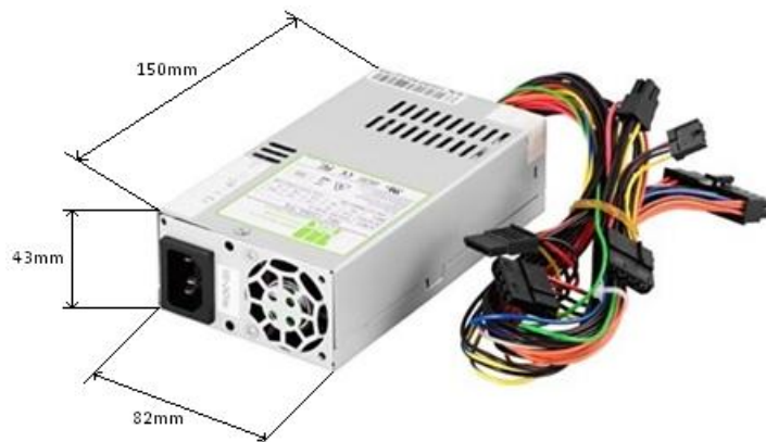
Kuva 4.7 Compucasen 120W virtalähde, jossa on etuosassa tuuletin sekä liitinpaikka virtakaapelille. Virtalähteen takaa tulee liittimiä, joilla saadaan siirrettyä virta halutuille tietokoneen piirilevyille virtalähteeltä. Kuva muokattu. (Verkkokauppa a 2013)
