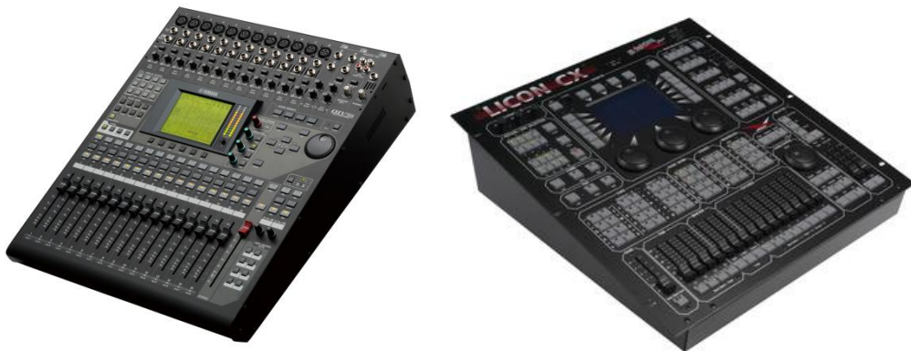
Kuva 4.2 Vasemmalla on äänisignaalin käsittelyssä käytettävä konsoli ja oikealla valo-ohjauksessa käytettävä konsoli. Kummastakin konsolista huomataan kiilamainen muoto sekä liukupotentiometrien ja painokytkimien yhtenäiset sijoitustavat. (Yamaha 2013), (JB-Lighting 2013)
