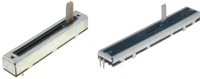
Kuva 4.1 Vasemmalla yleinen liukupotentiometri ja oikealla pölysuojattu liukupotentiometri. Oikeanpuoleisen potentiometrin valmistaja on pyrkinyt suojaamaan uraa lialta, toisin kuin vasemmanpuoleisessa. (TME a 2013), (TME b 2013)
