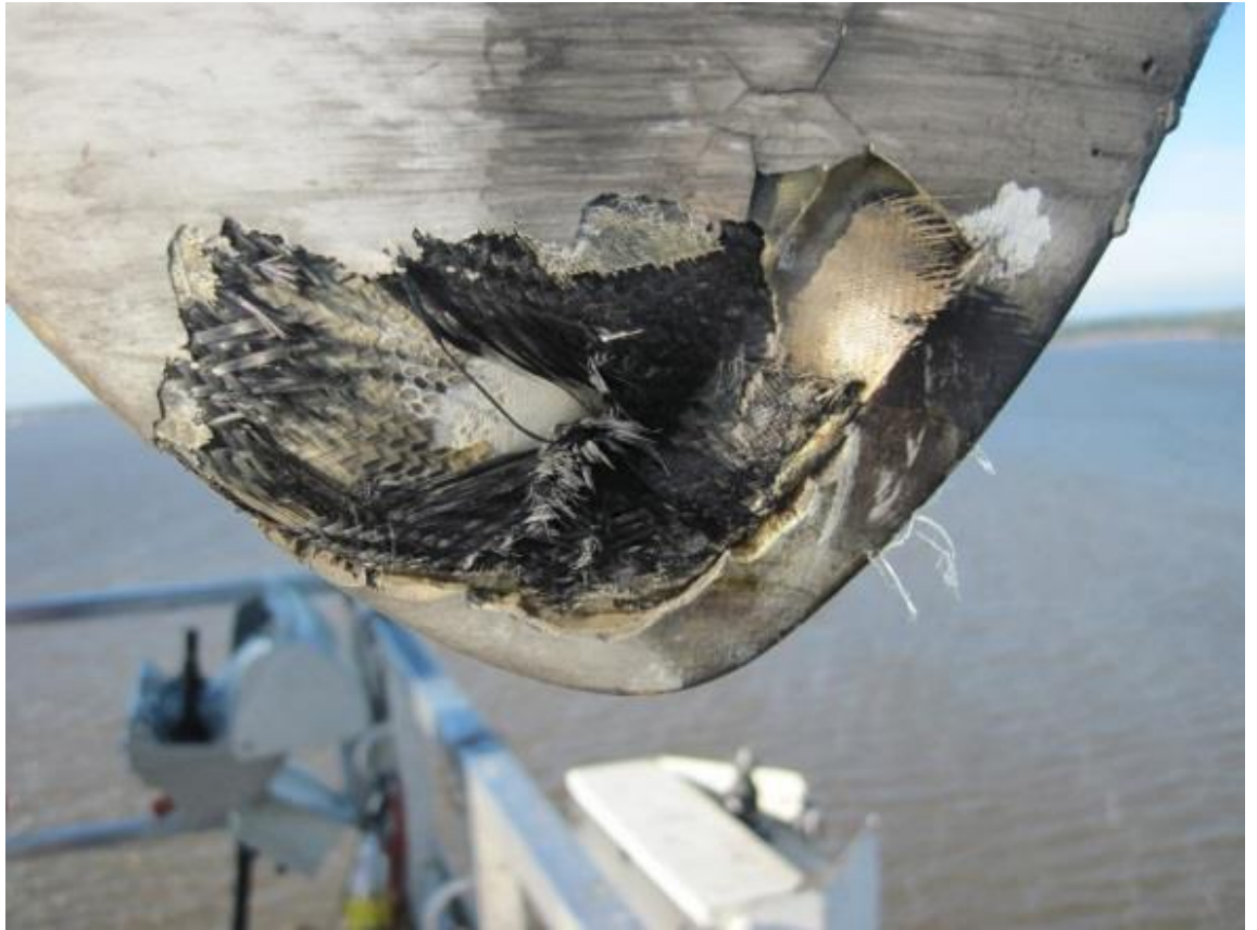
Kuva 6: Salamaniskun ja veden höyrystymisen aiheuttama vaurio lavan kärjessä (Bladefence)
