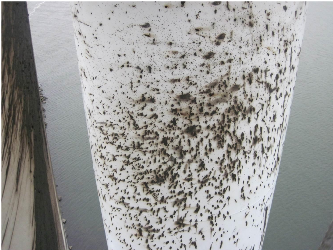
Kuva 5: Kuvassa hyönteisten aiheuttamaa likaantumista (Bladefence)
