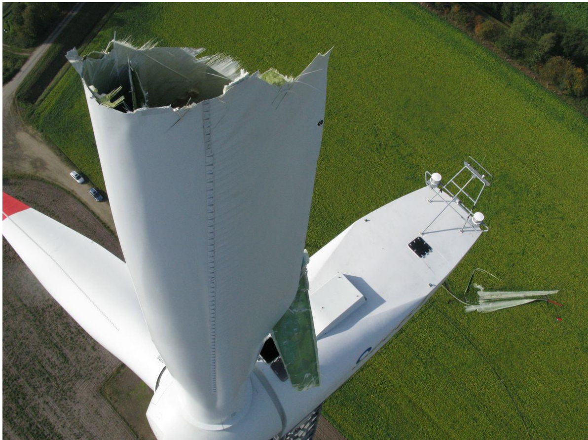
Kuva 4: Katkennut tuulivoimalan lapa (Gurvits F. Airice)
