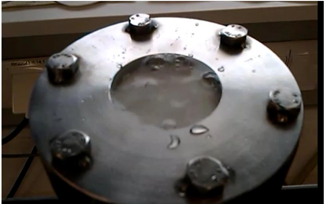
Kuva 23 Kuplapisteen silmämääräinen määrittäminen läpäisylaitteella.
