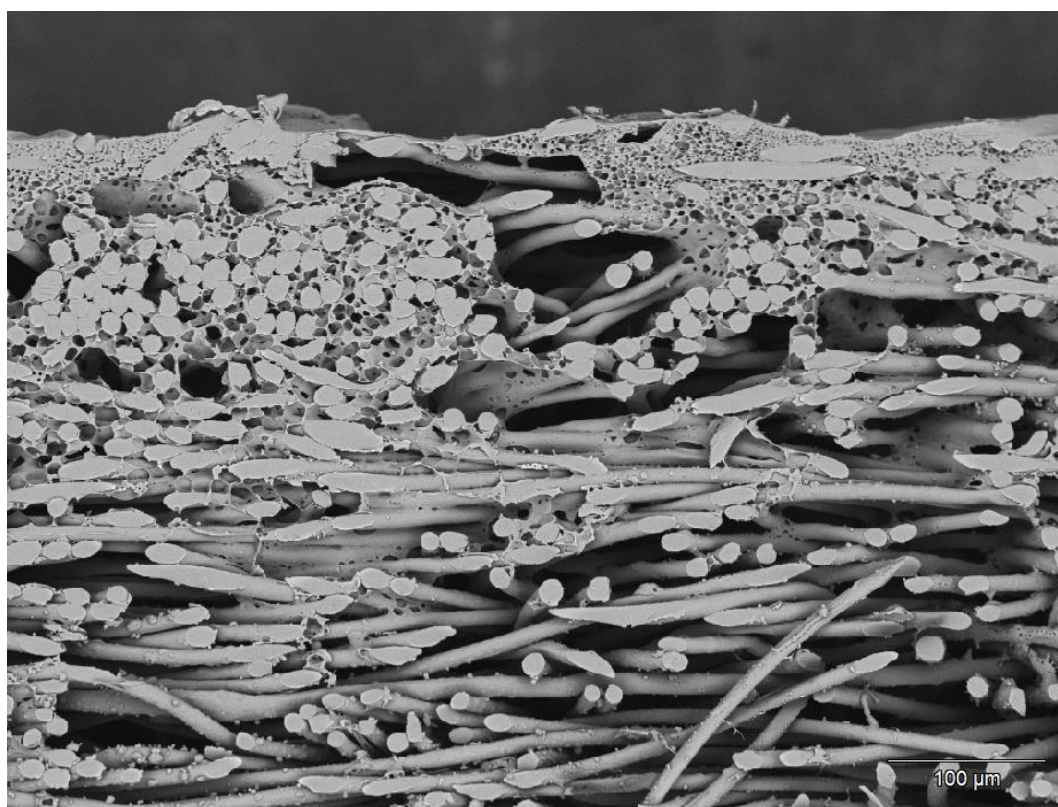
Kuva 38 14 % polyamidilla pinnoitetun yhdeltä puolelta kalanteroidun kankaan (koesarja 5, näyte 3) SEM:llä otettu poikkileike.
