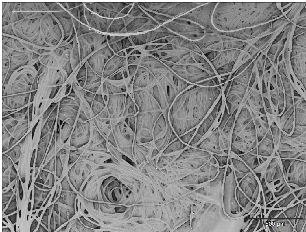
Kuva 35 Dispersioaine-vesi-suhteella 1:4 pinnoitettu kangas. Kankaassa on kolme dispersioainekerrosta.
