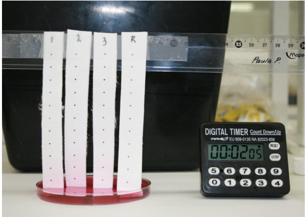
Kuva 21 Elintarvikevärikokeiden koejärjestelyt. Väriin absorptioaika kankaaseen oli 3 min.
