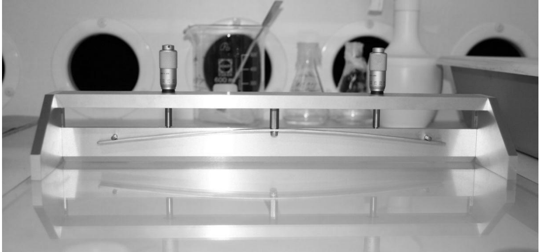
Kuva 20 Kaupallinen BYK–Gardnerin pinnoitteen tasaiseen levittämiseen käytettävä kaavari.
