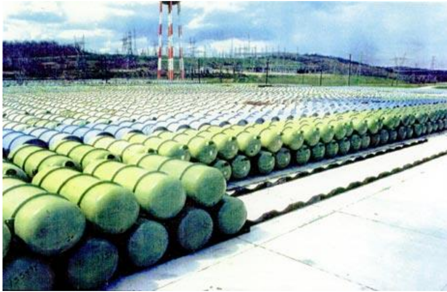
Kuva 14. UF 6 säilytyspiha. (Argonne National Laboratory, 2000)
