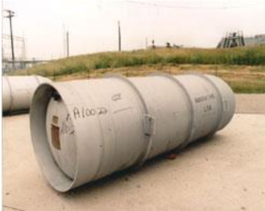
Kuva 13. Uusi UF 6 -säilytys sylinteri. (Argonne National Laboratory, 2000)
