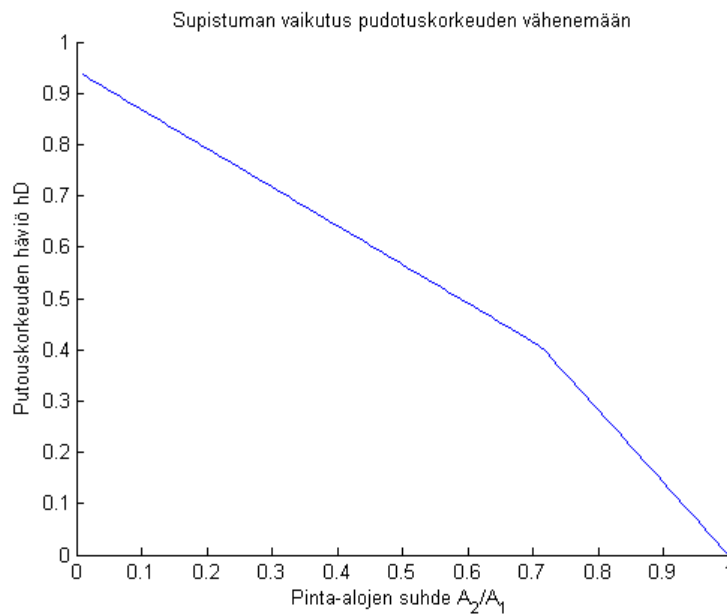
Kuva 6.1: Supistuman vaikutus putouskorkeuden menetykseen. X-akselilla supistuma ja y-akselilla putouskorkeuden menetys. Eli mitä enemmän pinta-alat eroaa toisistaan, sitä suurempi supistuma.
