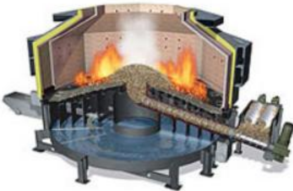
Kuva 5. BioGrate-arinan toimintaperiaate [MW Power (a)]
