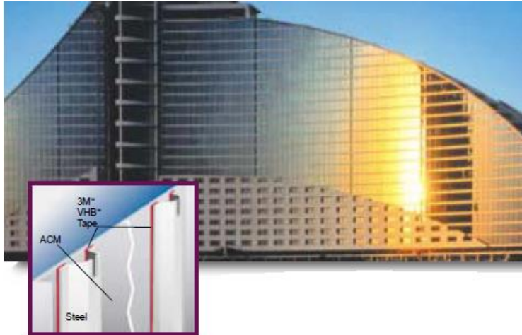
Kuva 3. Rakennuksen ulkoseinän paneelien kiinnitys. (3M, 2008c, s. 7)
