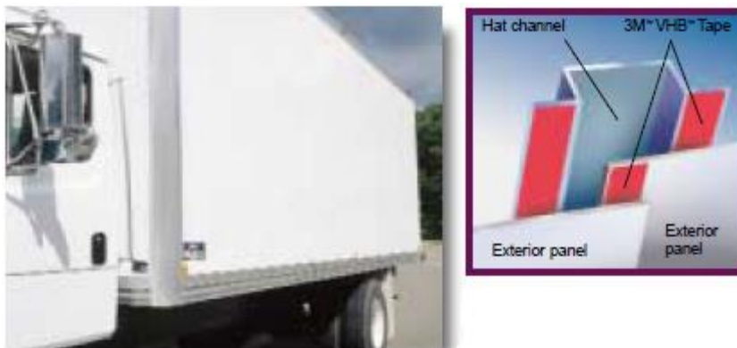
Kuva 4. Kuorma-auton sivupaneelien kiinnitys runkoon. (3M, 2005b, s. 5)
