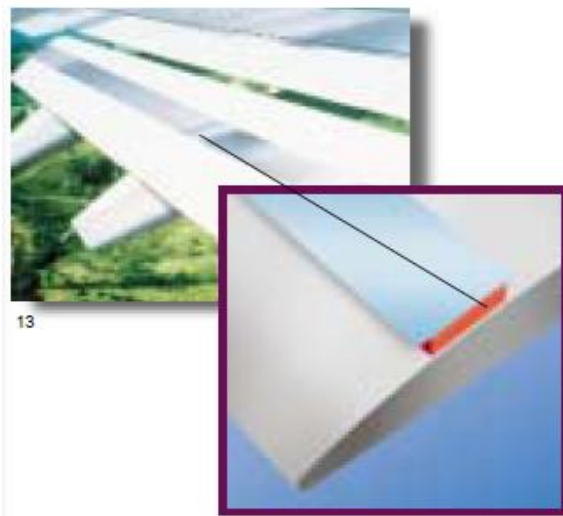
Kuva 2. Lentokoneen siiven laskusiivekkeen kulumaliuskan kiinnitys. (3M, 2005b, s. 4)
