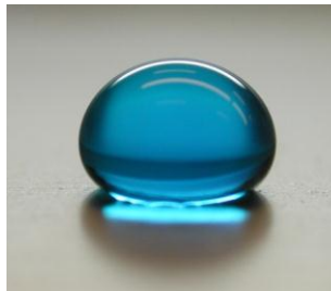
Kuva 6. Siniseksi värjätty vesipisara superhydrofobisella pinnalla, joka hylkii voimakkaasti vettä. Tällöin vesi palloutuu ja vierii herkästi pinnalla. /10./
