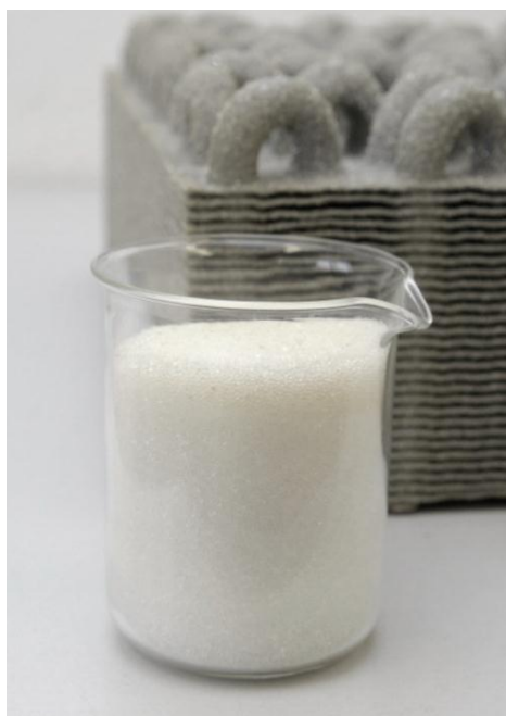
Kuva 15. Silikageeliä mitta-astiassa sekä osa SorTechin adsorptiojäähdyttimen lämmönsiirtopinnasta. (SorTech 2013).
