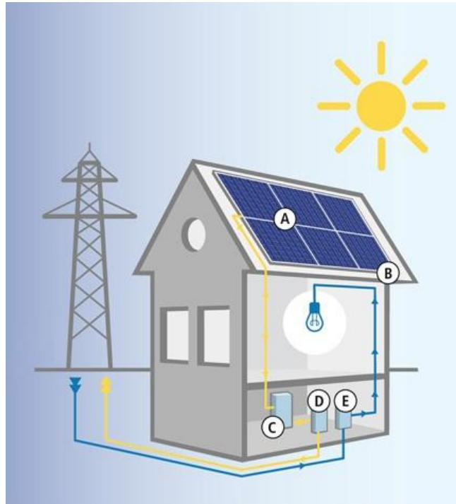
Kuva 7. Verkkoon kytketty aurinkosähköjärjestelmä. Kuvassa A = Aurinkopaneeli, B = Aurinkopaneelin kiinnikkeet, C = Inverteri, D = Tuotetun sähkön mittari, E = sähkön kulutusmittari. (Sharp Electronics Europe, 2012.)
