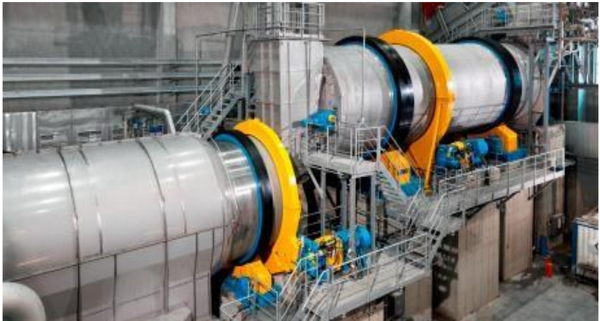
Kuva 1. Rumpumallinen keräyspaperimassan käsittelylaitteisto (Voith).
