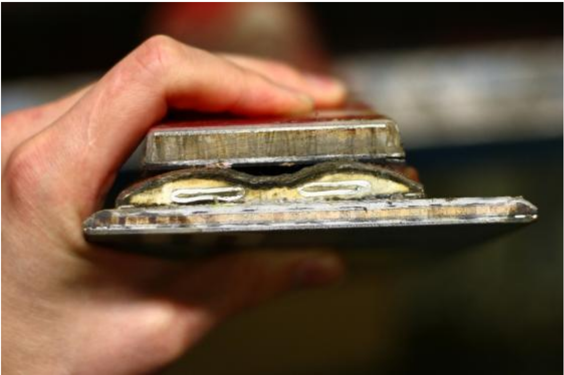
Kuva 4. Eri suksimallien poikkileikkauksia. (Salminen, 2010.)
