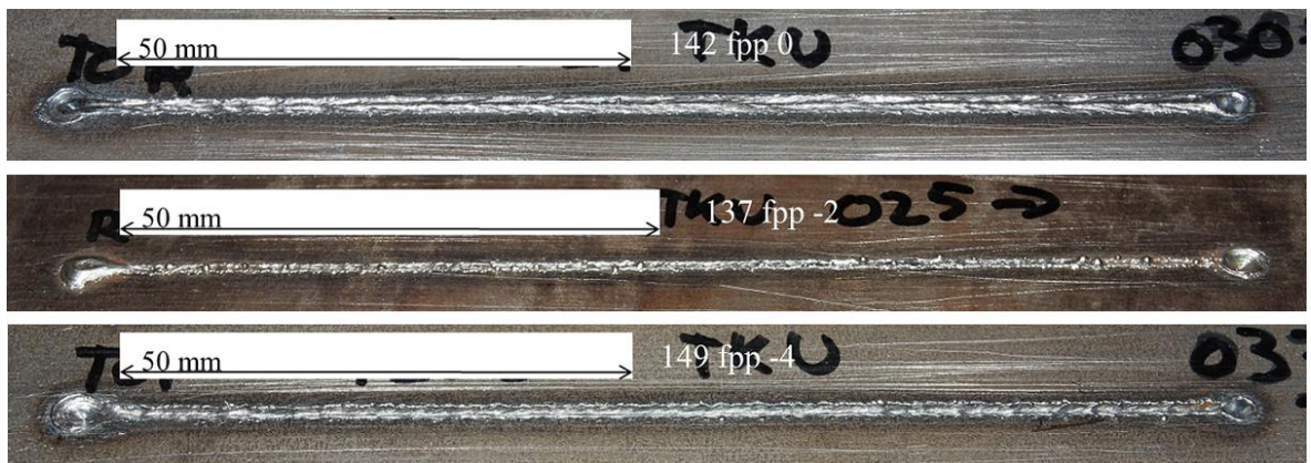
Kuva 34. Hitsien kuvat ja roiskeet eri polttopisteen asemilla 0, -2 ja -4 mm (ylhäältä alas).
