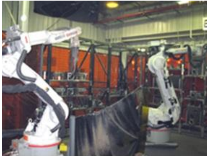
Kuva 8. Midmark Corp:n robottihitsaussolu. (Carlson. 2011)
