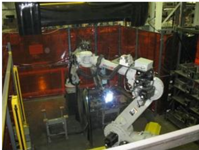
Kuva 10. Kappaleenkäsittelijärobotti hitsaussolussa. (Carlson. 2011)
