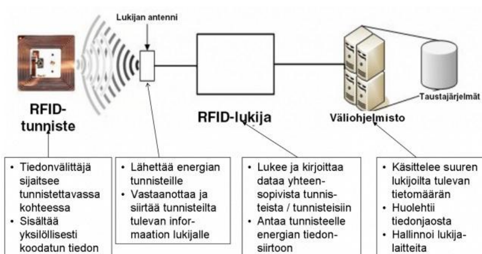
Kuva 1. RFID-järjestelmän rakenne (RFIDLab Finland Ry. 2012d)
