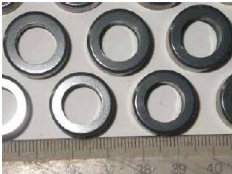
Kuva 10. Koesarjana valmistettuja rengasmaisia polttoainepellettejä. (Lahoda et al. 2007b, 107)
