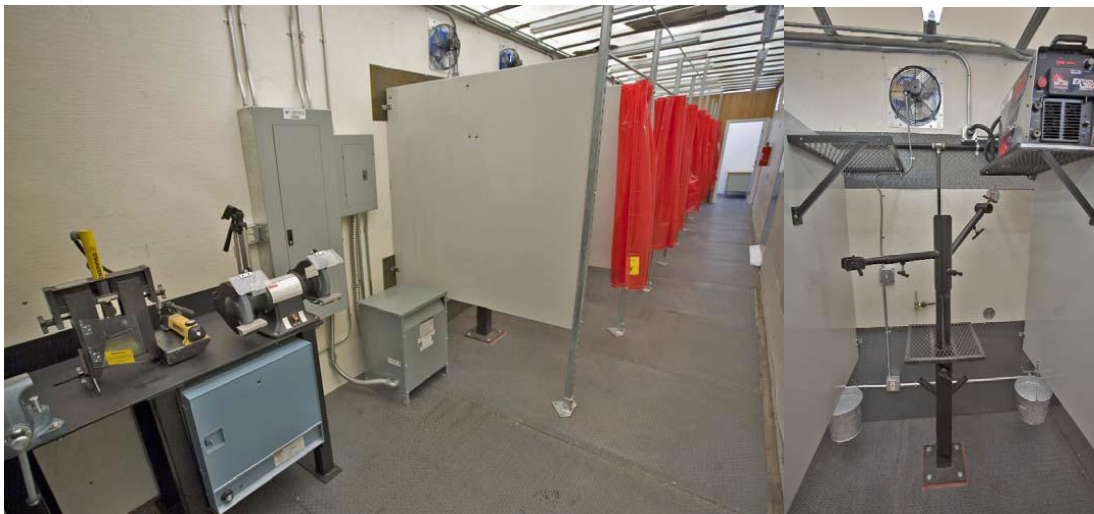
Kuva 31. Kansainvälisen hitsaustarvikkeiden ja palveluiden vuokrausyrityksen Red-D-Arcin hitsaamoksi varustelema rekan perävaunu (Red-D-Arc, 2014).
