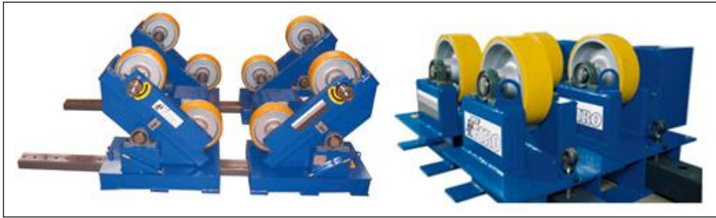
Kuva 22. Itsesäätyvä- ja normaalirullasto (Firotec, 2013).
