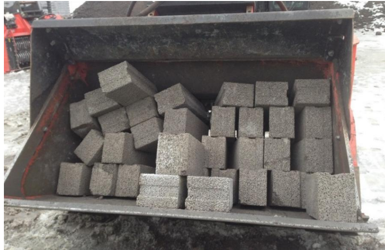
Kuva 24. Kauhaan asetetut lecaharkot murskaustestejä varten.
