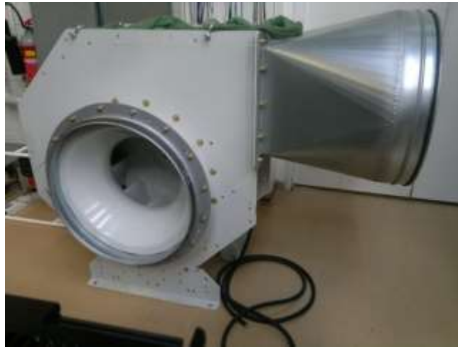
Kuva 6. Mittauksissa käytetty Fläktwoods in puhallin Centripal EU 4 MD 630.
