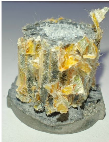
Kuva 28. Huokoinen piikikäs-insertti tason normaalisuuntaisen vetokokeen jälkeen
