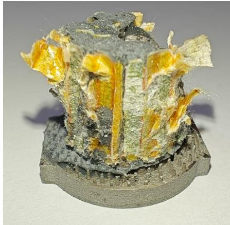
Kuva 24. Joustava insertti tason normaalisuuntaisen vetokokeen jälkeen
