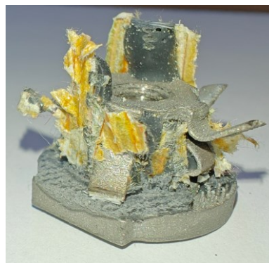
Kuva 25. Ristimutteri-insertti tason normaalisuuntaisen vetokokeen jälkeen
