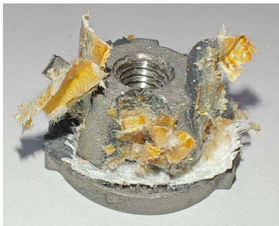
Kuva 36. Ristimutteri-insertti tasonsuuntaisen vetokokeen jälkeen
