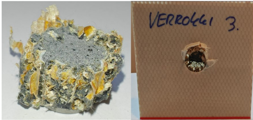
Kuva 32. Verrokki-insertti ja kerroslevy tasonsuuntaisen vetokokeen jälkeen
