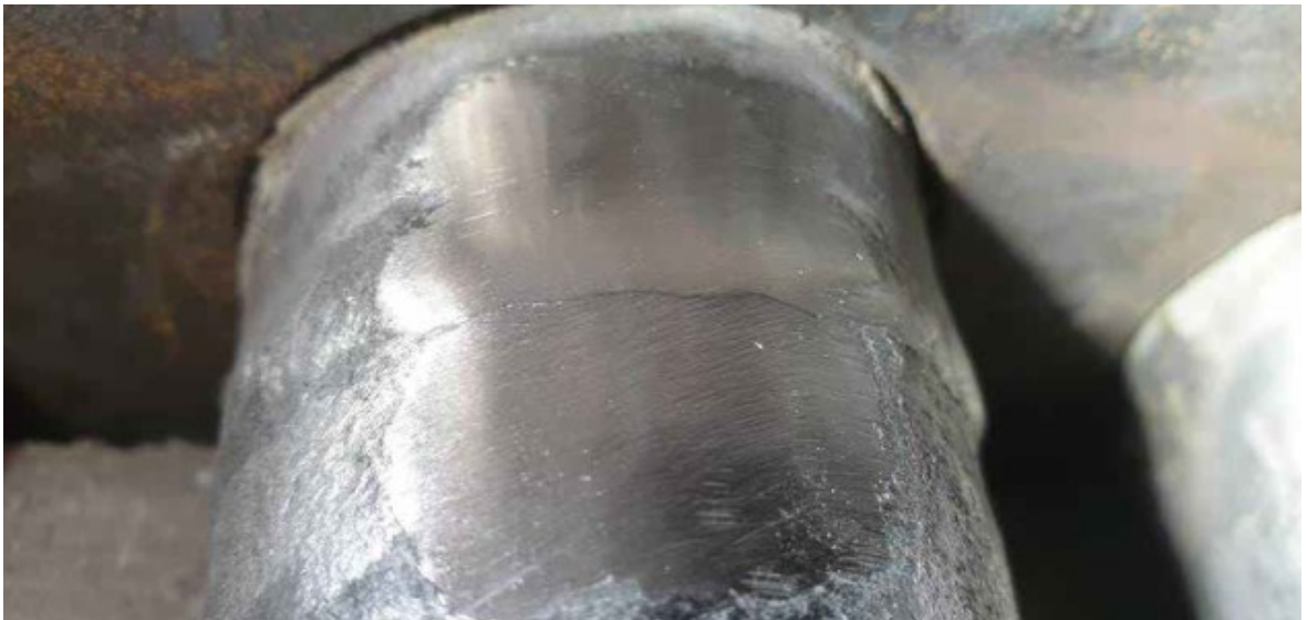
Kuva 28. Reunahaavaa hitsausliitoksessa (UPM sisäinen dokumentti 2024).
